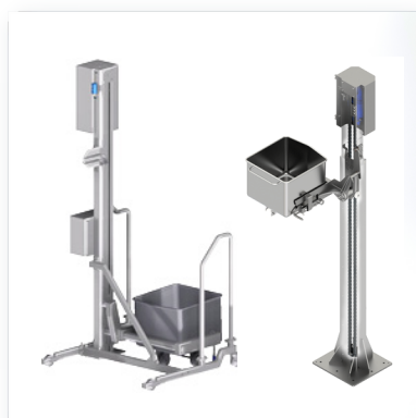
Załadunek masztowy mobilny lub stacjonarny do 300kg Typ ZM-200 do wózków 200 lub 300 l
